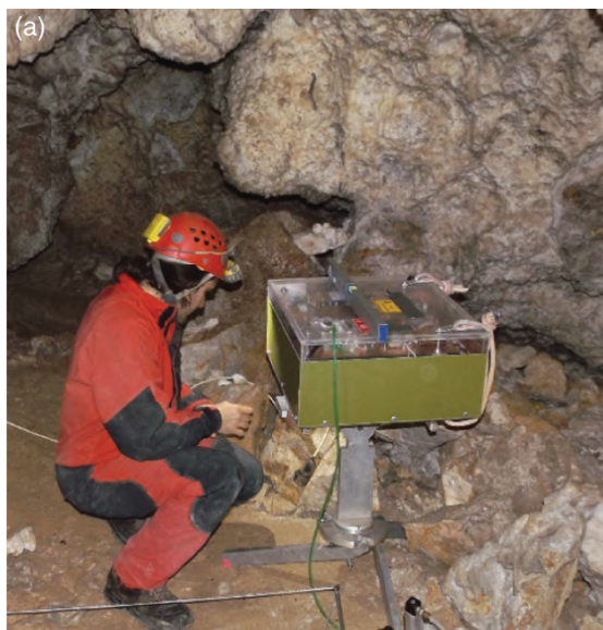
8. ábra. Müográf detektor telepítése barlangban [19]
