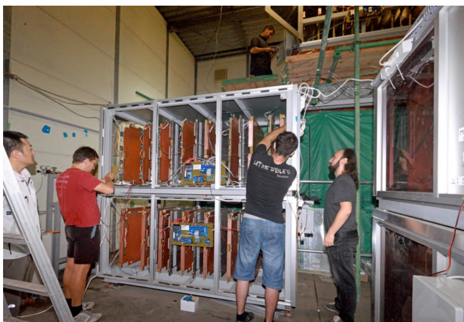
7. ábra. Az SMO detektorrendszer telepítése Japánban [18]
