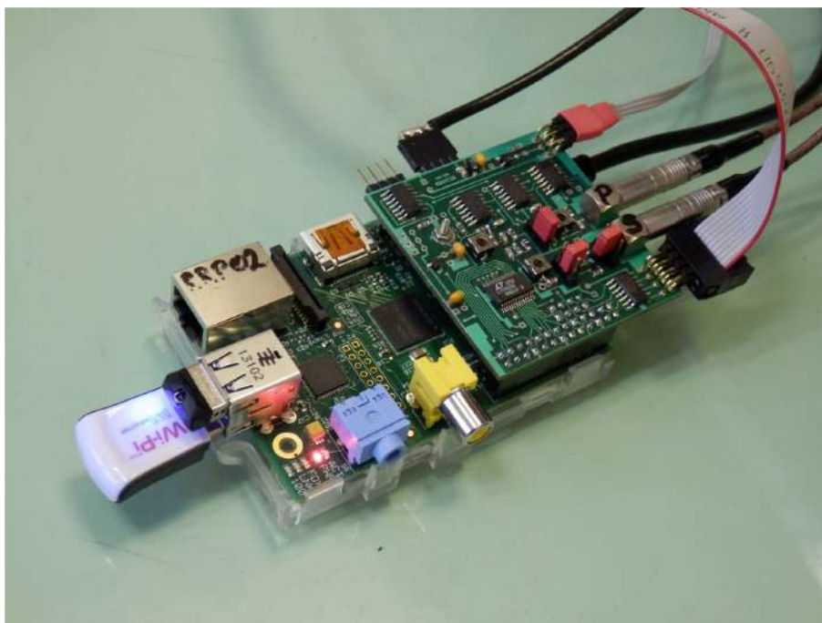
2.8. ábra. A RaspberryPi egykártyás számítógép, a Leopard lelke. Rá csatlakozik felülről az LRD kártya [18].
