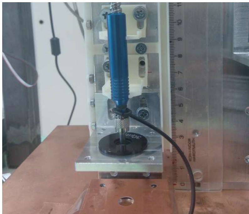
3.4. ábra. A deutérium lámpa optikai szálának vége, rögzítve a pinhole fölött.
