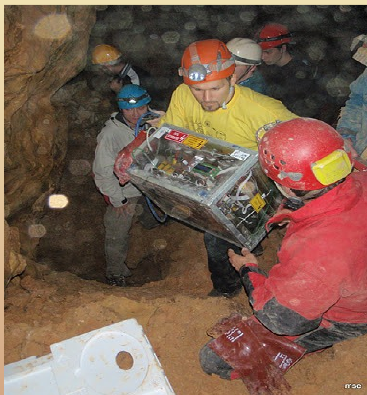
4. ábra: A Müontomográf elhelyezése a 60 méter mélyen található Ajándék-barlangban.
