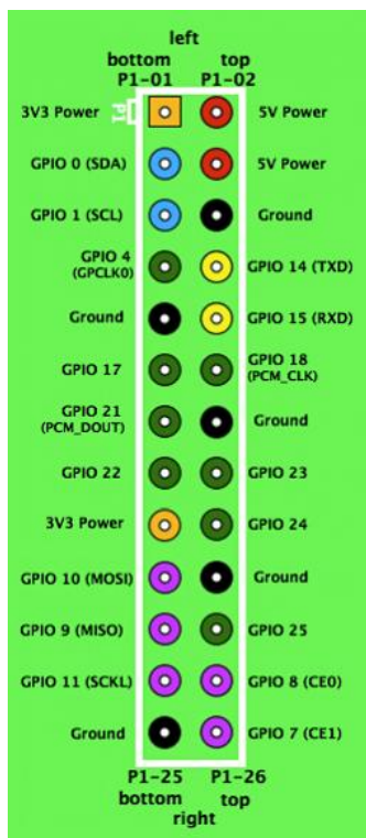
18. ábra RPi GPIO BCM lábkiosztás [14]
