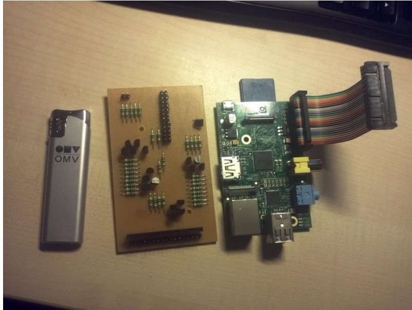
30. ábra Az elkészült feszültség átalakító NYÁK-on
